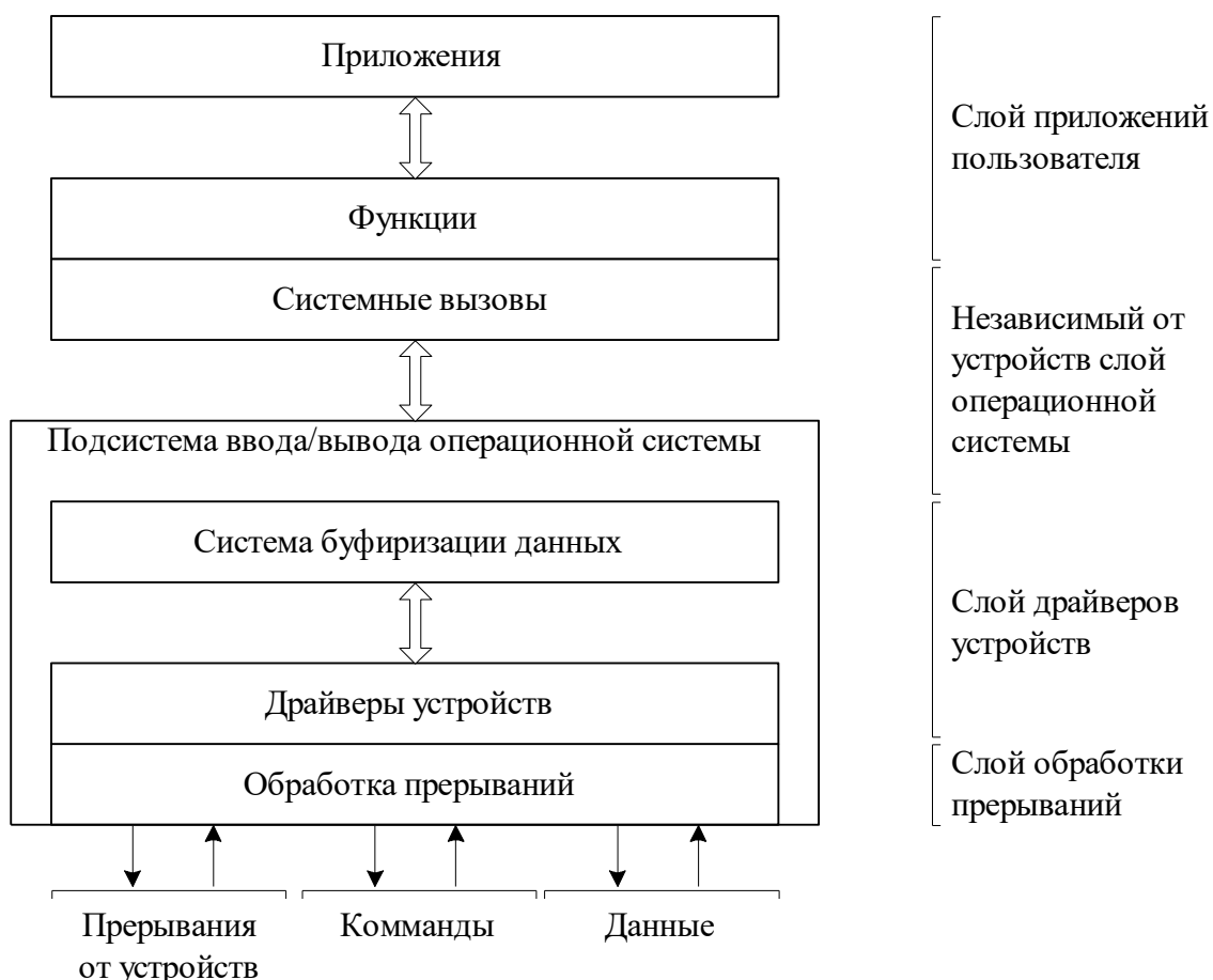
Рис. 4.1. Иерархия слоев ввода/вывода
